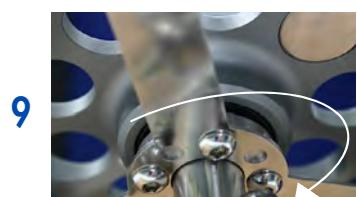
**Fig 9 & 10 -** Le guide inox est orientable et permet d'aligner au mieux la drosse par rapport au plan de pont du bateau. Se conformer aux dispositions de mise en œuvre (voir notice de montage).
