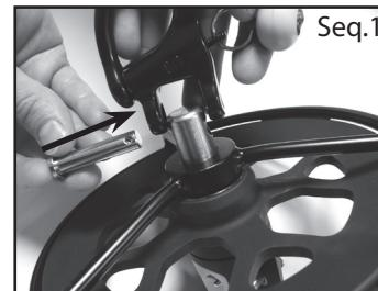
Insérer l'axe dans le mousqueton et le moyeu du système (tête de l'axe vers le bras du mousqueton). Puis installer l'anneau brisé. Vérifier que le mousqueton est bien positionné verticalement.
